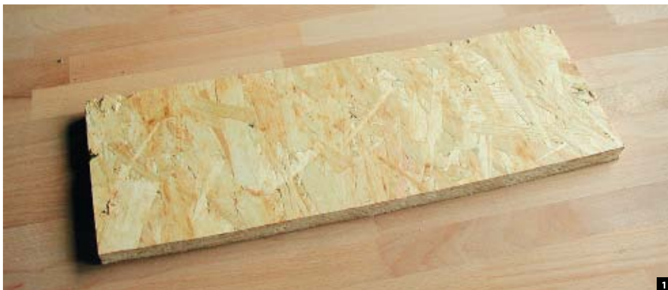
Abb. 1: Diese OSB-Platte zeigte auffällige Ausdünstungen durch Terpene und Aldehyde.
